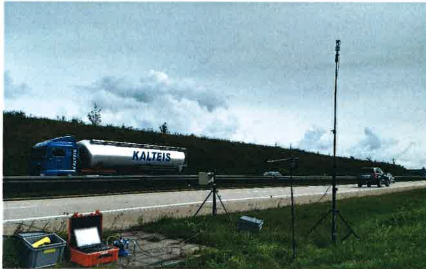
Abbildung 2. Beispielhafter Messaufbau nach der Statistischen Vorbeifahrtmethode (SPB).
