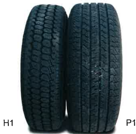
Abbildung 3. Verwendete Messreifentypen P1 und H1 gemäß [CPX2].
