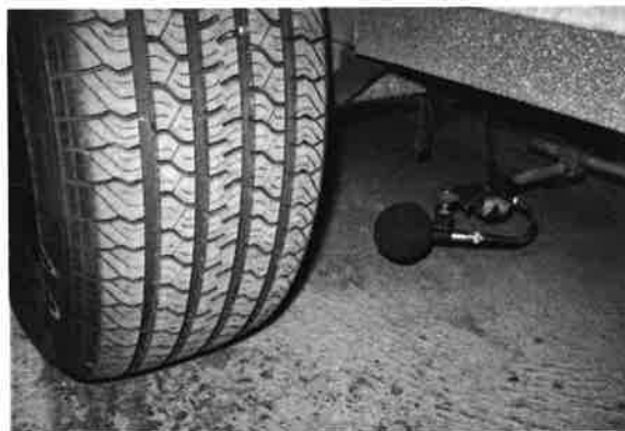
Abbildung 5. Reifen P1 mit Messmikrofon (obligatorische Mikrofonposition vorne).
