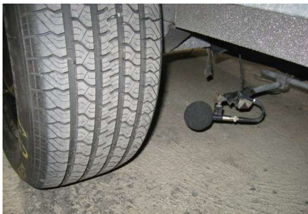
Abbildung 5. Reifen P1 mit Messmikrofon (obligatorische Mikrofonposition vorne).
