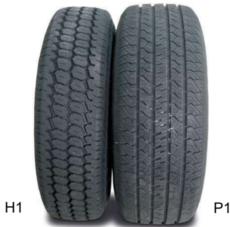
Abbildung 3. Verwendete Messreifentypen P1 und H1 gemäß [CPX2].
