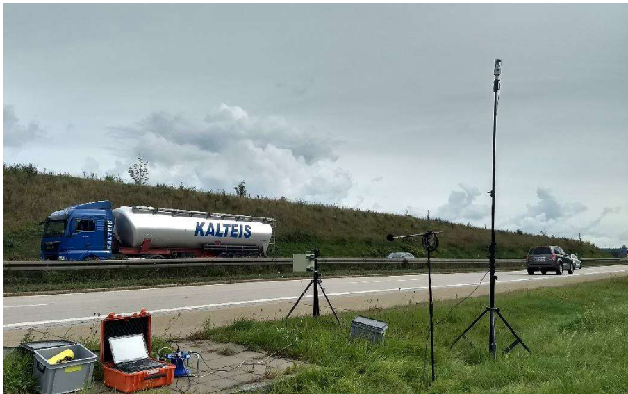
Abbildung 2. Beispielhafter Messaufbau nach der Statistischen Vorbeifahrtmethode (SPB).
