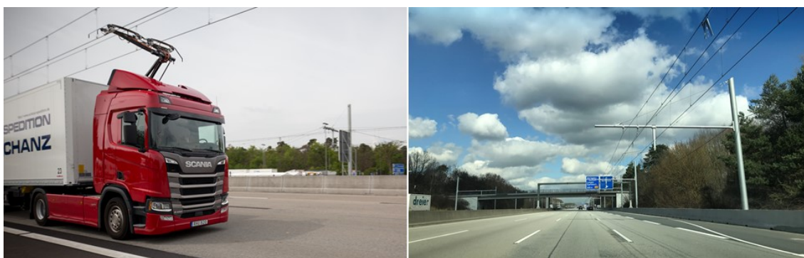
Abbildung 1: OH-Lkw auf dem ELISA-eHighway (links: Rynkowski 2019; rechts: IVV 2019)
